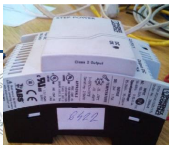
Image 11 Rectifier (power supply)
